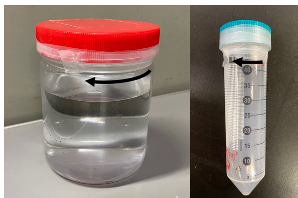
図6 液漏れしないように容器の蓋を固定する。 広口のネジ蓋容器を使用し、蓋を締める方向に パラフィルム等を巻いて固定する（矢印）。
